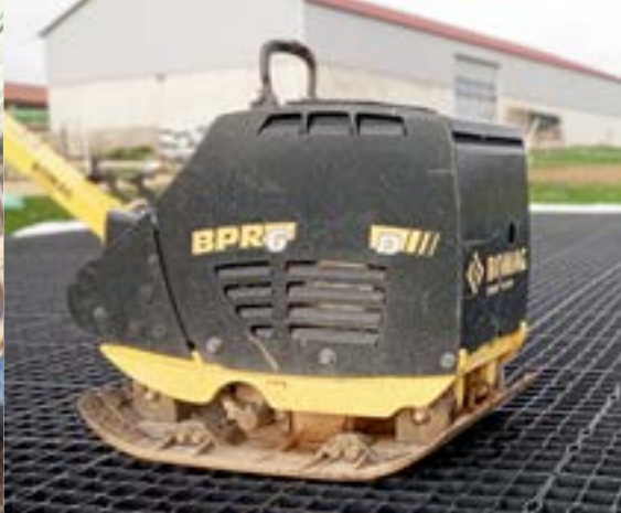
Abrütteln vor der Verfüllung
